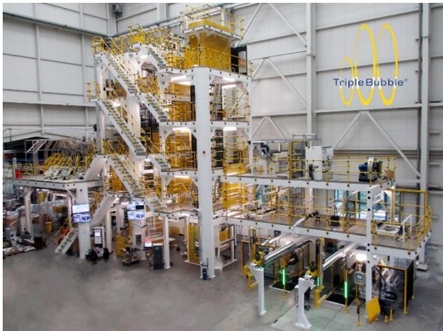
*Les lignes de production de films soufflés Triple Bubble® de taille moyenne de Kuhne atteignent une capacité de production de 250 kg/h pour la fabrication des films rétractables à haute barrière, qui sont souples et recyclables. © Kuhne Anlagenbau*
